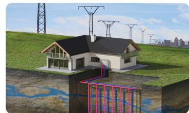
Figure ( 42 ) Chauffage géothermique des bâtiments
