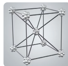
Figure ( 22 ) Le réseau cristallin du fer
