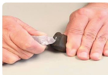
Figure ( 13 ) mesure du degré de la dureté
